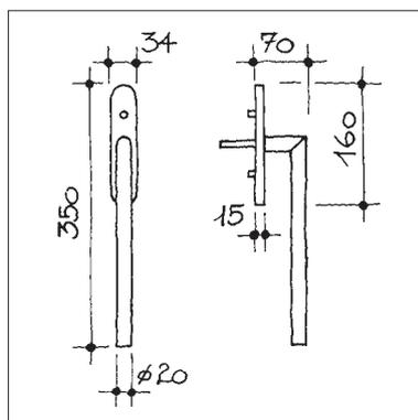
**Poignée à levage pour porte coulissante, convient pour la ligne BERNINA, sur plaque de base massive avec positions d'arrêt à billes, distance de fixation 80 mm, tige 10x50 mm**
